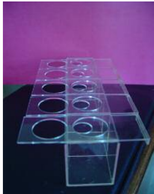
شکل ۱: نمونه قفس تست مورد استفاده در متد اصلاح شده. در این روش قفس تست به ۵ خانه مجزا و مساوی تقسیم می‌گردد.
